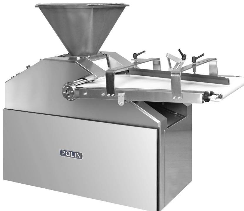
Spezzatrice volumetrica con sistema a depressione adatta a lavorare paste tenere e di media consistenza con percentuali d'acqua superiori al 55%.
