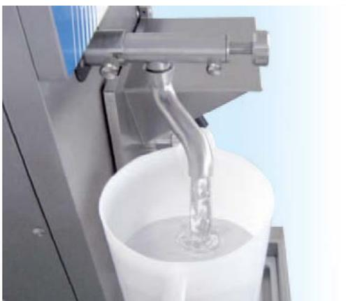
**Rubinetto esterno** per il passaggio della miscela, consente anche lo scarico diretto dell'acqua di lavaggio.
