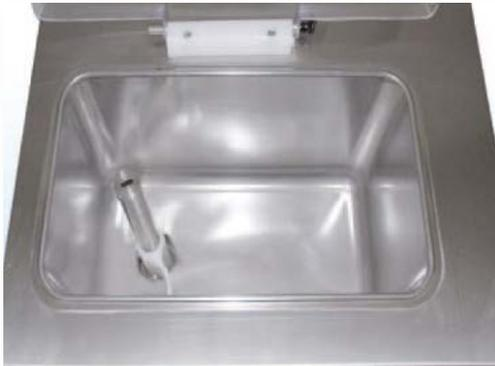
**Vasca di miscelazione e riscaldamento.** Il riscaldamento avviene tramite circolazione di glicole (bagnomaria) che evita le bruciature del prodotto. La miscelazione efficace degli ingredienti, direttamente in vasca, è eseguita con motoriduttore che evita la formazione di schiuma. Il controllo preciso della temperatura consente 3 programmi modificabili per soddisfare tutte le esigenze.
